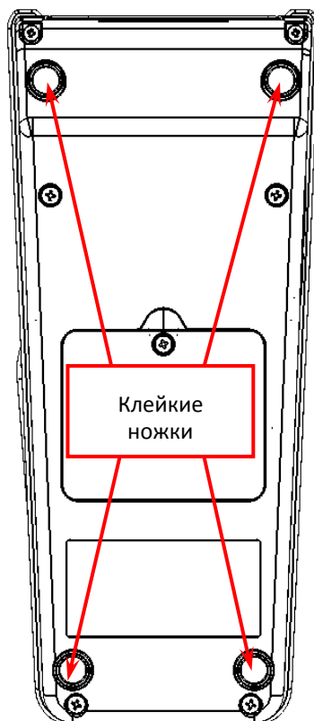
Рисунок 34. Установка клейких ножек на дно изделия
